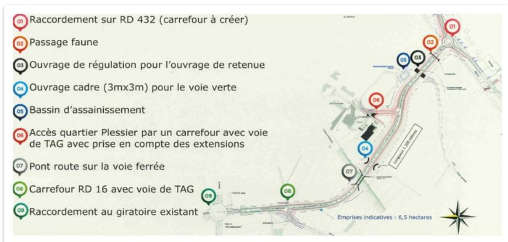
Cet aménagement routier sera construit sur une retenue d'eau dont le but est de protéger la basse ville d'Altkirch des effets dévastateurs d'une prochaine crue centennale. Dans le fonctionnement normal, l'Ill s'écoule directement en aval de Carspach et un dispositif est mis en place pour pouvoir permettre l'épanchement des eaux dans le lit majeur de l'Ill sur le ban de Carspach, de la future voie vers l'amont.
